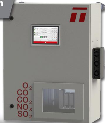
Diese Komplettlösung stellt ein kompaktes und kosteneffizientes Gasanalyse-System für die kontinuierliche Emissionsüberwachung (CEMS) dar.
